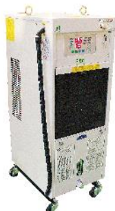
主軸冷卻裝置 Spindle cooling system
